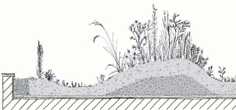
Principe de mise en œuvre d'un substrat d'épaisseur variable
